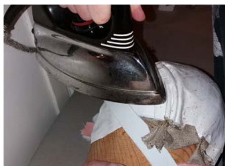
Bild 15. a) Papper limmas med rågmjölsgrot på ett fodertyg. b) Mitsömmen sys och hamras slät och sätts på stocken. c) Stommen stryks slät. Foto: Eija Mendelin 2020.
